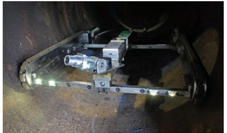
SMALL VGC ROBOTIC INSPECTION CRAWLER FOR LIVE GAS MAINS
